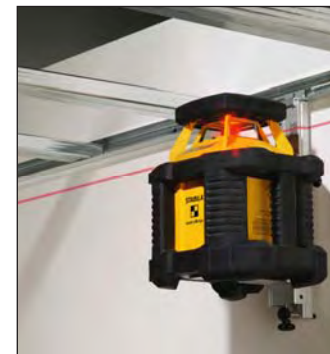
Consolă nivelare Tip NK 100 Ideal pentru interioare: consolă nivelare cu reglare pe înălțime (suport de perete) pentru laser rotativ. Se agață cu șine profil sau cui. Spectrul de aplicare: agățare tavane, turnare strat nivelare.
